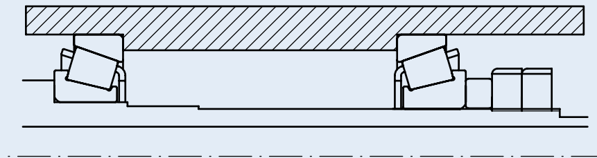
(d) Position preload without spacers
